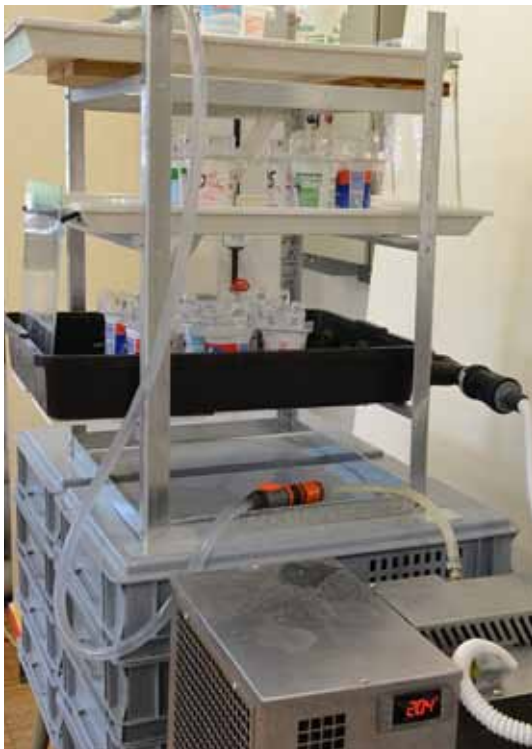
Das Herzstück – und gleichzeitig der teuerste Bestandteil – der Eintagsfliegen-Zuchtanlage ist das Kühlaggregat (im Vordergrund). (Foto: Peter Weichselbaumer)
